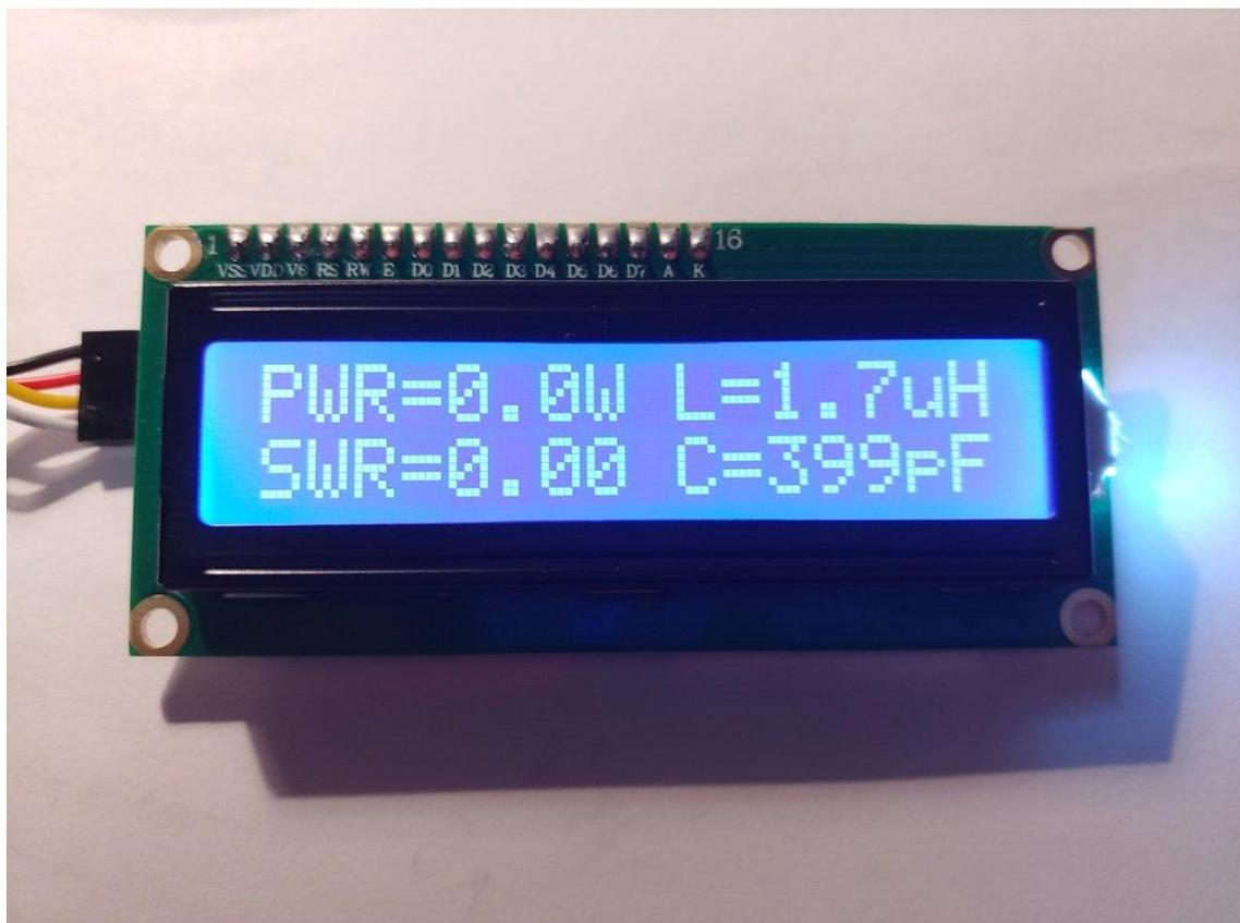
Die linke Seite der Anzeige zeigt den Leistungsdurchsatz und das SWR an. Es wird der Peak-Detektor-Modus verwendet, der es ermöglicht, die Signalleistung
